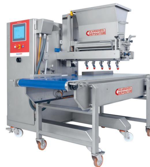
Durch eine praxisorientierte Bedienungseinheit lassen sich bis zu 100 verschiedene Produktprogramme leicht und schnell eingeben. Die Verwendung auch an bestehenden Produktionslinien macht die Maschine zu einem Multitalent für das Füllen und Dosieren. Mit einer Geschwindigkeit von 20 bis 40 Takte/Min. Lassen sich, je nach Produktbeschaffenheit, eine breite Palette von Massen und Füllungen verarbeiten.
